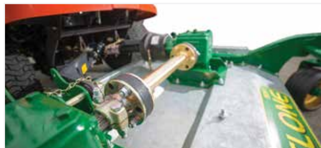
Robuste Bauweise und zahnradgetriebenes Messersystem
