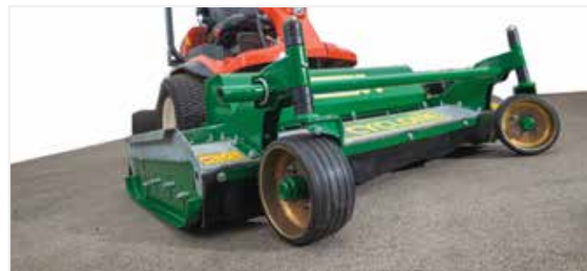
Schnitt Höhenverstellung zwischen 10 und 110mm
